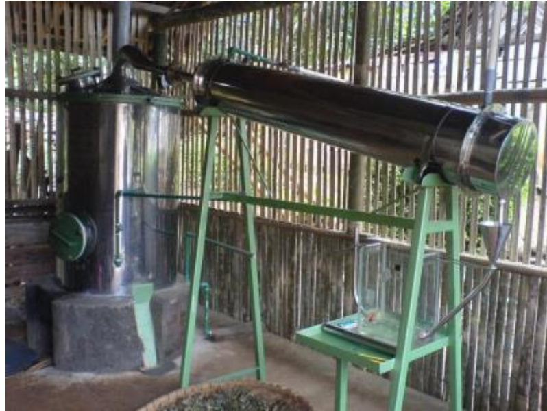
Gambar 3.2 Penyulingan Nilam dengan metode penyulingan uap langsung
